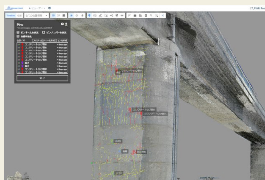
図9 点検写真から自動生成した3D点群
