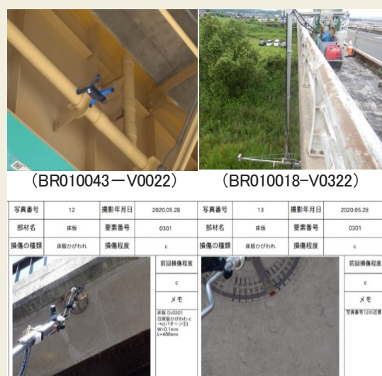
図7 実際に使われた点検ロボットと写真(様式10)
